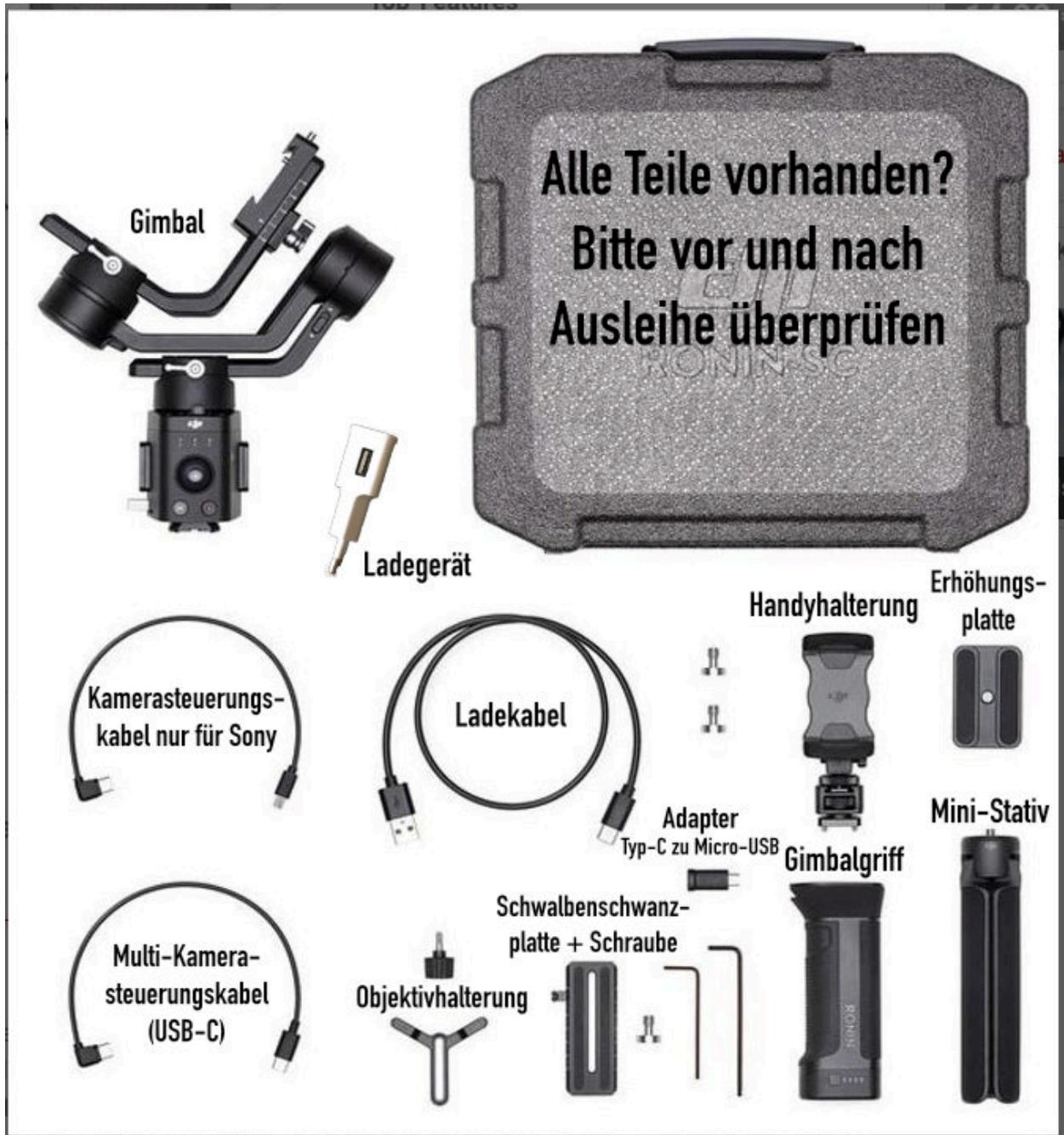
Bitte die Befestigungsschraube an der Schwalbenschwanzplatte belassen
