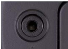
Wenn Sie den Blitz über Ihre Kamera auslösen möchten (Betrieb mit Kabel), verbinden Sie ein PC-Synchronisierungskabel mit dem PC-Synchronisierungsanschluss an Ihrer Kamera und mit der 3,5 mm Monobuchse an der NEO 2-Lampe. (Wenn Ihre Kamera keinen PC-Synchronisierungsanschluss hat, können Sie optional den Adapter „Rotolight Zubehörschuh-auf-PC“) kaufen und das PC-Blitz-Synchronisierungskabel. Damit verwandelt sich Ihr Zubehörschuh in eine PC-Buchse).
