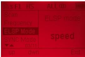
Scrollen Sie im Einrichtungsmenü runter bis zur Option „ELSP“. Bleiben Sie in diesem Untermenü und drehen Sie das Funktionsrad auf den Modus „SPEED“. Drücken Sie dann auf die Taste in der Mitte des Funktionsrads, um den Geschwindigkeitsmodus zu aktivieren. (Das Transmitter-Display sollte jetzt rot werden).
