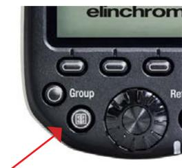
Blitztesttaste (Einfaches Drücken = Rechtsklick, Doppeltes Drücken = Linksklick von Neo 2)
